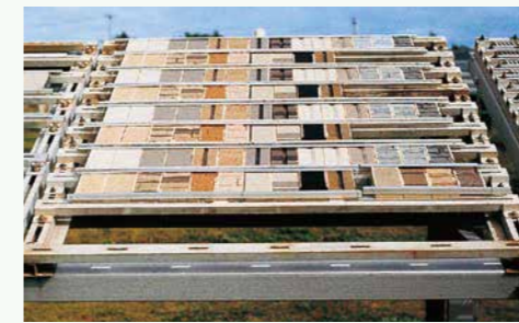
<宮古島暴露試驗場> 暴露在比一般地區約3倍的紫外線和風雨更苛刻的條件下，實施室外暴露試驗，觀察其經過。
